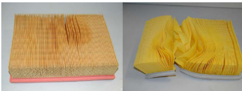
Slika 8: originalni zračni filter BMW (levo) in Champion U 607 (desno) po poskusu z vodo
