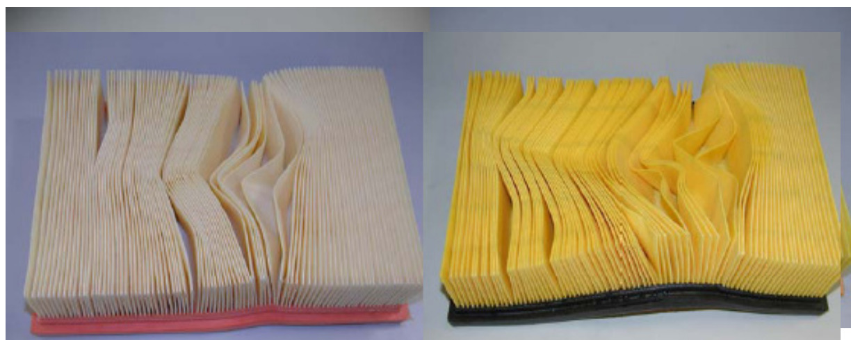
Slika 10: Purmux A 214 (levo) in Purolator A 27001 (desno) po poskusu z vodo Slika 11: Filtron AP 028 (levo) in Technocar A 411 (desno) po poskusu z vodo
